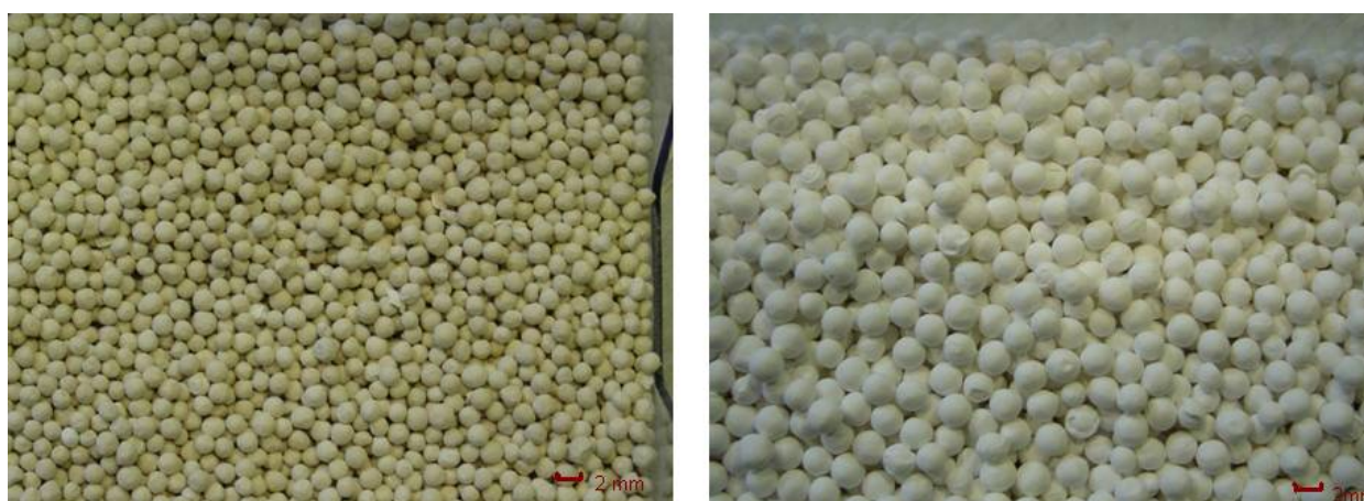
Figure 2 : Zéolites (à gauche) et alumines activées (à droite)
